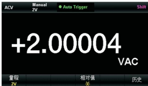
图 2-8 交流电压测量界面
