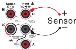
图 2-28 温度测量示意图
