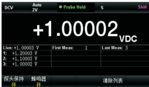
图 3-10 DCV Hold测量界面
