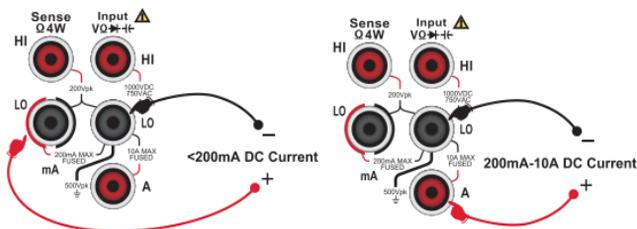
图 2-7 直流电流测量连接示意图
