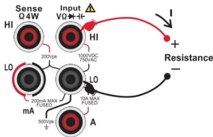
图 2-14 二线电阻测量连接示意图
