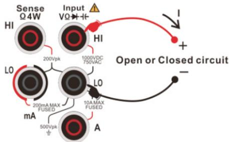
图 2-24 连通测量连接示意图
