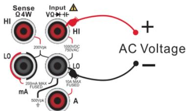
图 2-20 信号频率测量连接示意图
