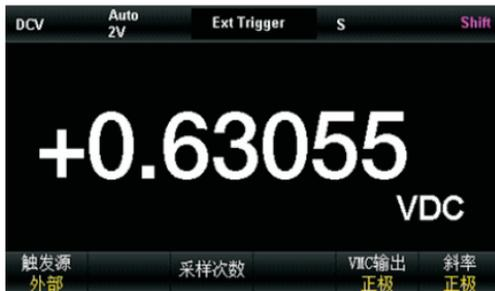
图 2-38 外部触发设置界面
