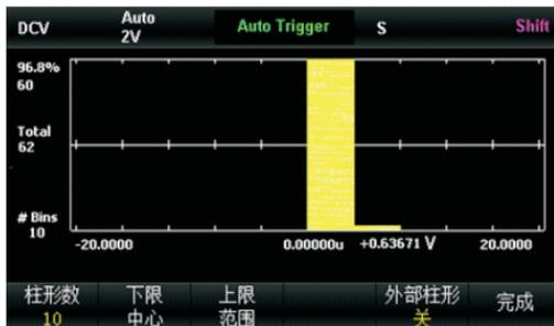
图 2-51 直方图手动设置界面
