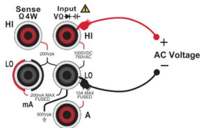
图 2-9 交流电压测量连接示意图
