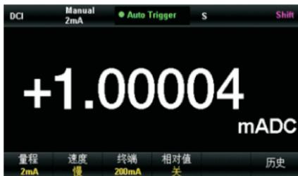
图 2-6 直流电流测量界面
