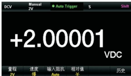
图 2-4 直流电压测量界面
