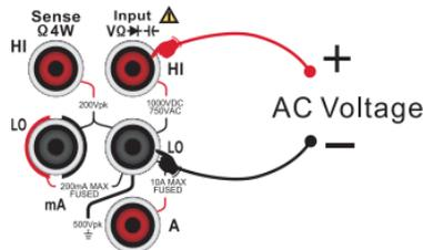
图 2-22 信号周期测量连接示意图
