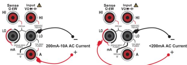
图2-12交流电流测量连接示意图
