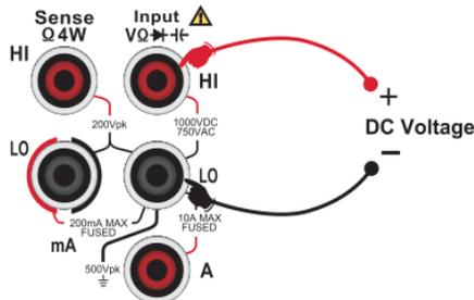
图 2-5 直流电压测量连接示意图
