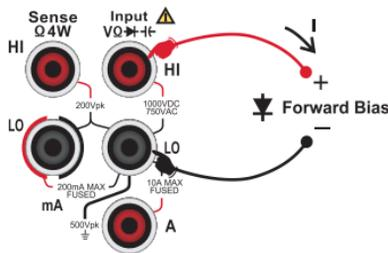
图 2-26 二极管测量示意图
