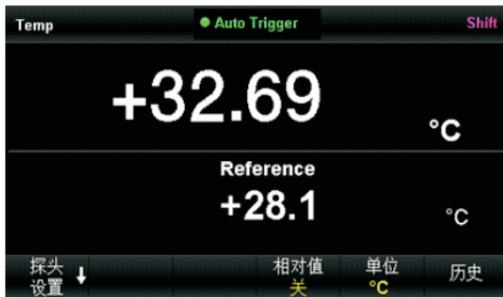
图 3-13 温度测量双显示界面
