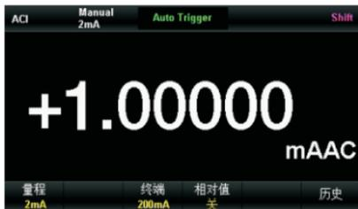
图2-11交流电流测量界面
