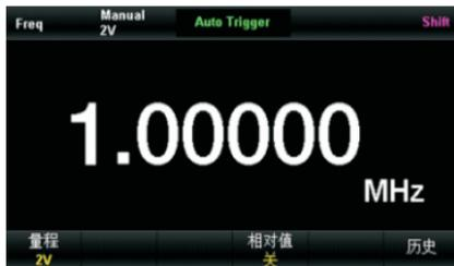
图 2-19 信号频率测量界面
