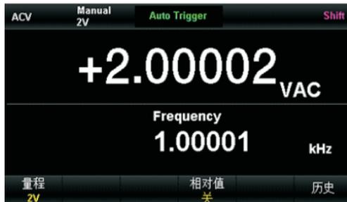
图 2-10 交流电压和频率测量界面
